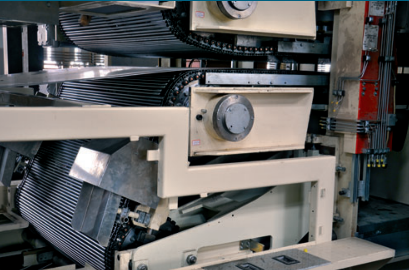
Rollstabteppich im Presseneinlauf
