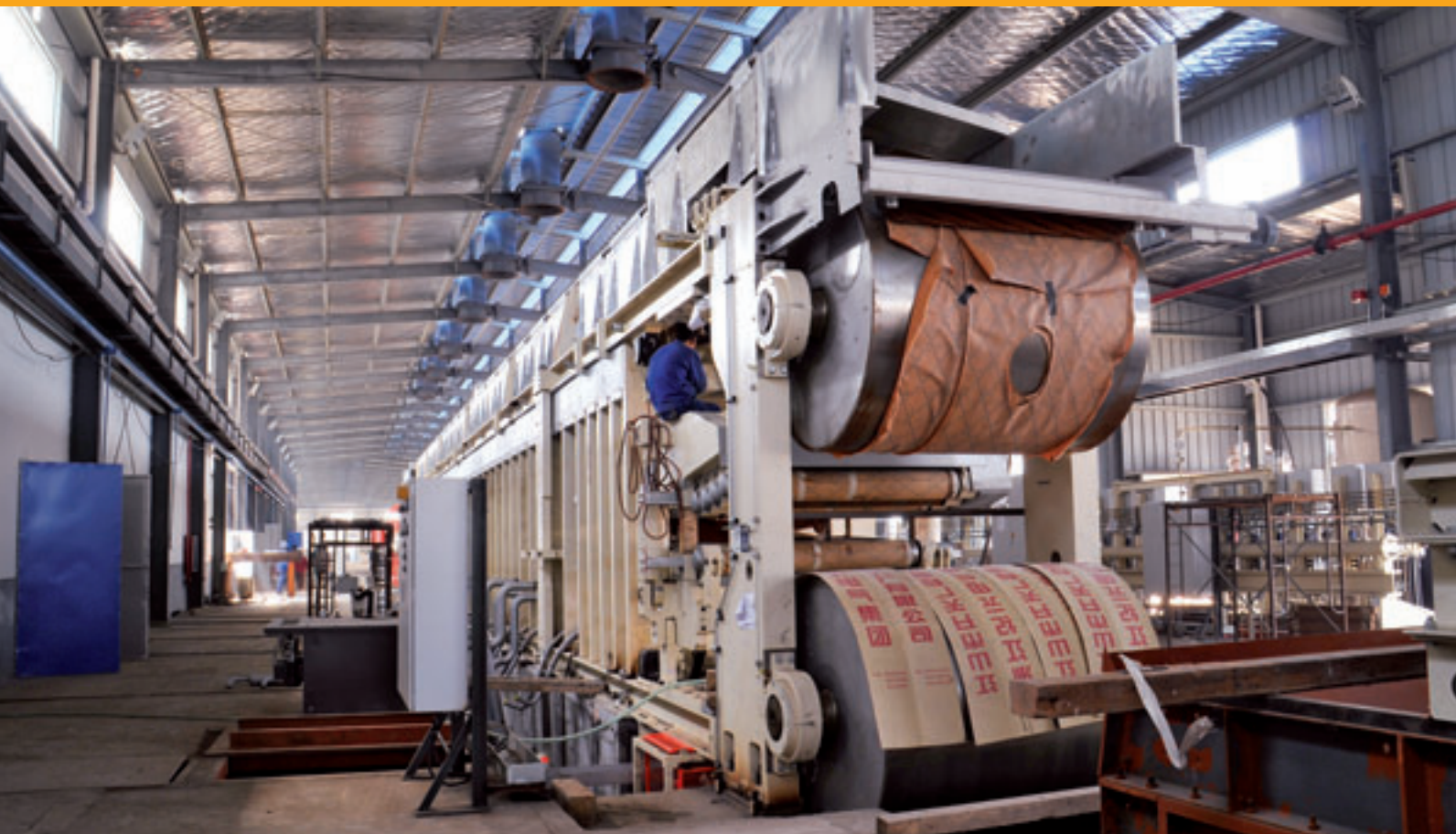
Die 4'-ContiRoll® im Rohbau
