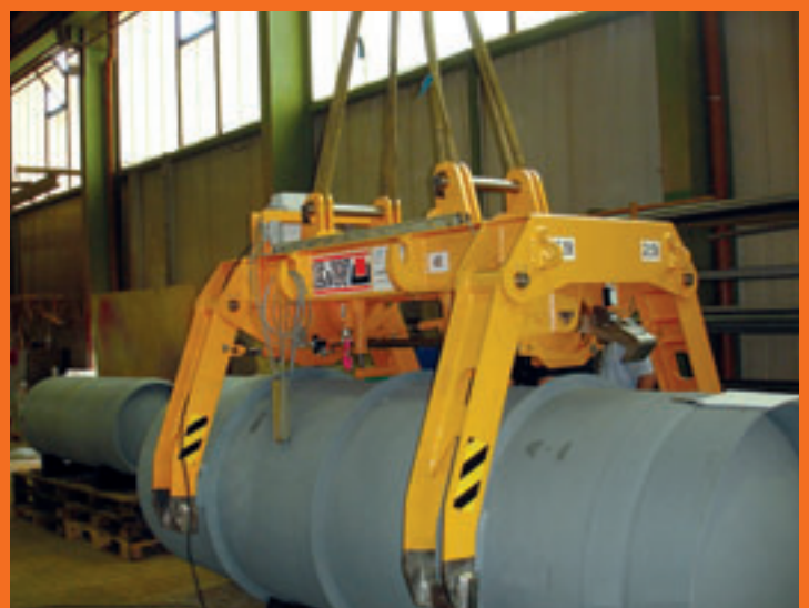
Greifer für UF 6 -Behälter für Urenco
