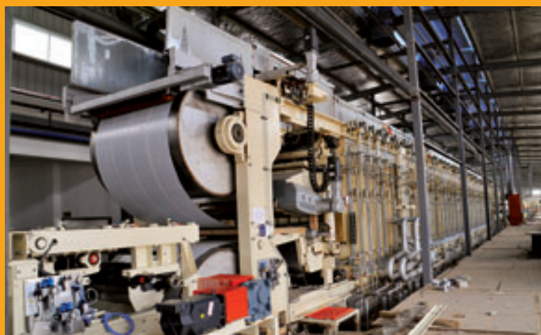
Presseneinlauf mit Stahlband
