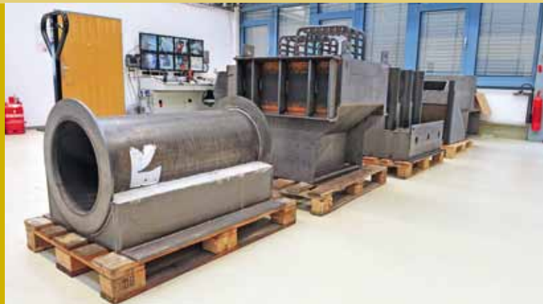
Realitätsnahe Probekörper im NIS-Technikum zum Test des Hot-Wire-Cutting-Verfahrens
