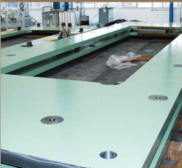
Die Rahmen der Tenaris O-Press in der Krefelder Fertigung
