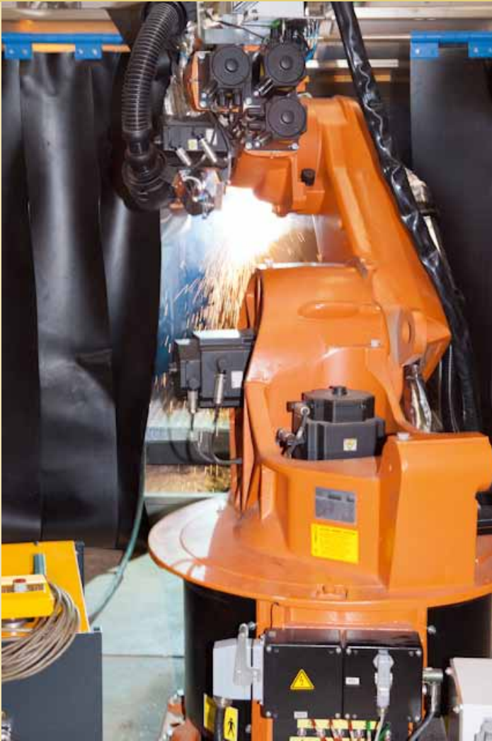
Das neue thermische Zerlegeverfahren im Teststand
