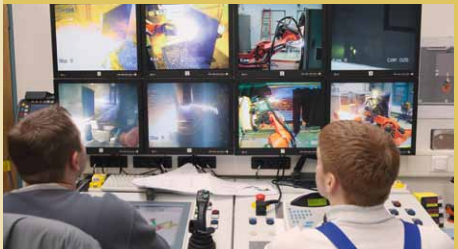
Fernbedientes Anfahren der Zerlegepunkte und Durchführung der Brennschritte unter Videoeinsatz im NIS-Technikum
