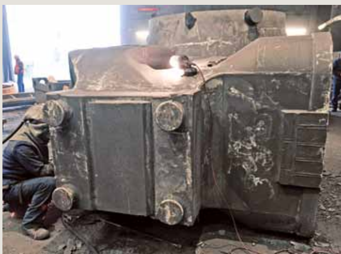
SACMI-Traversal erhält die letzten Schliffe in der Putzerei
