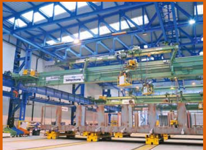
Sektionsausrüstung in der Produktionshalle 11 des MEYER WERFT Laserzentrums
