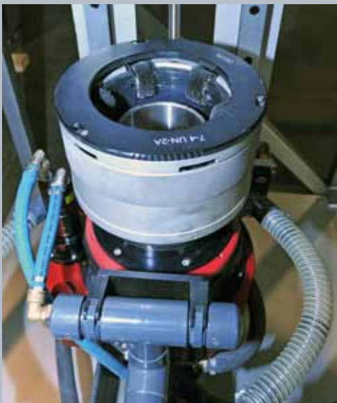
Mitte und unten: Innenansicht des Reinigungskopfes ausgerüstet mit sechs Rundbürsten aus Edelstahl zur Reinigung der Gewindebereiche am Bolzen
