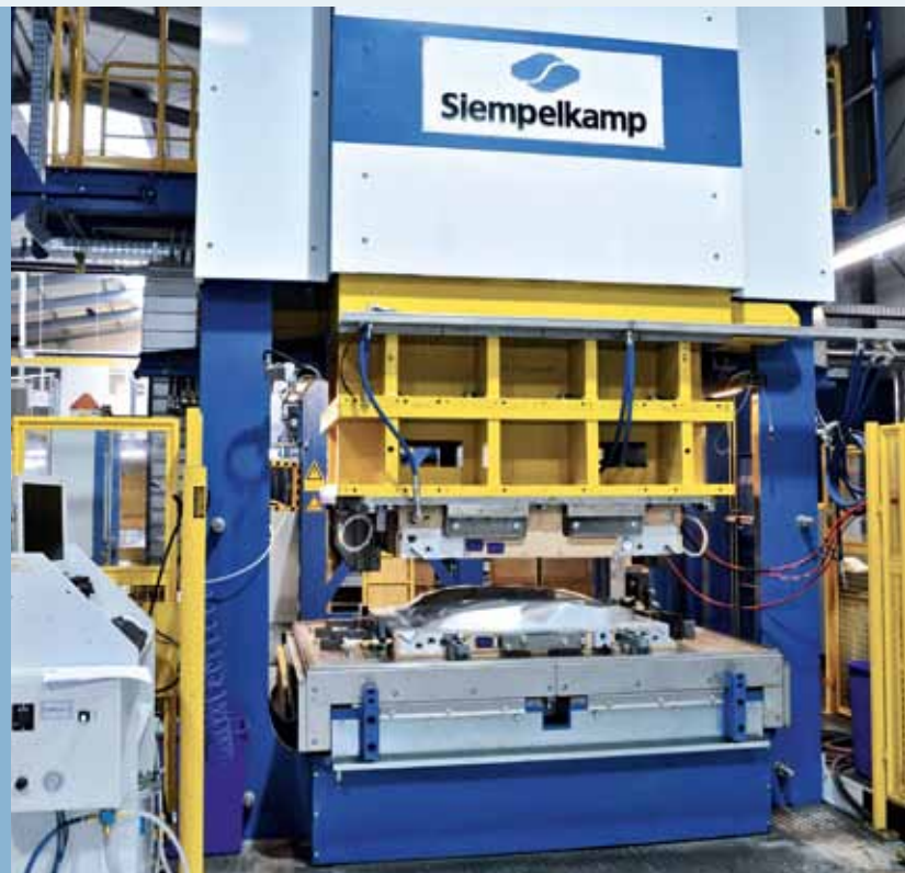
Spezialpresse für den RTM-Prozess
