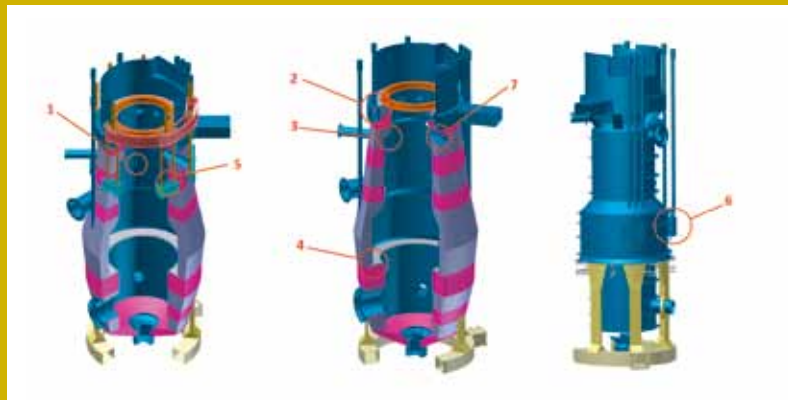
Beispiel: Stahleinbauten mit markierten Positionen der nachgebildeten Probekörper
