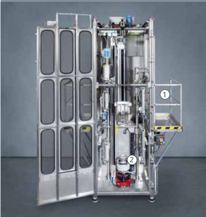
Oben und unten: Vollautomatisches Bolzenreinigungsgerät zum Einsatz in den Kernkraftwerken der EdF – ausgestattet mit einem speziellen EdF-Feature: einer Reinigungsstation zur Vorreinigung der RDB-Bolzen
