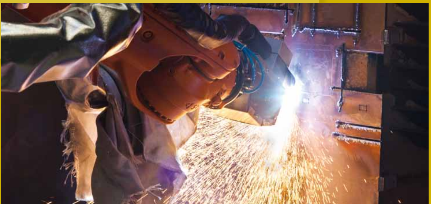
Erprobung des Hot-Wire-Verfahrens: Durchführung verschiedenster Brennschnitte
